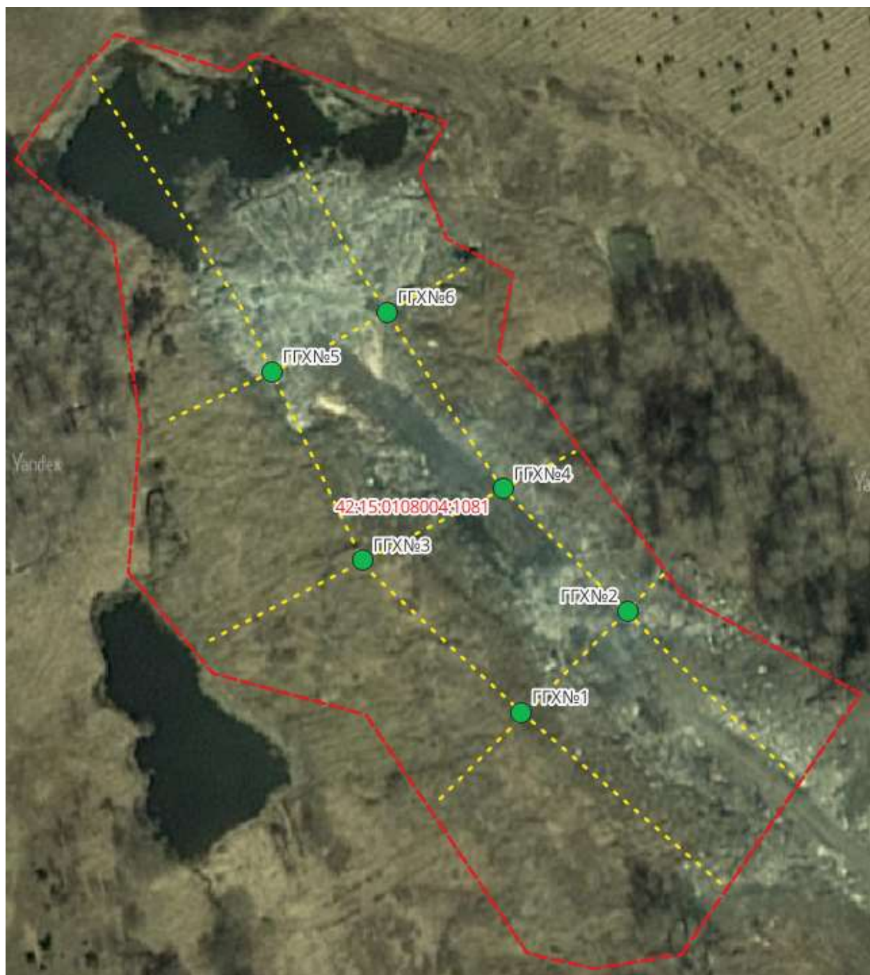
Рисунок 16 — Точки газогеохимических исследований грунтов
